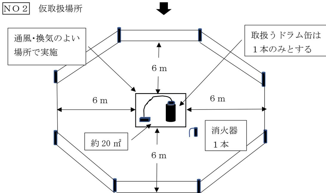
ドラム本体及び給油に使用するドラムポンプのアースを確保する。
